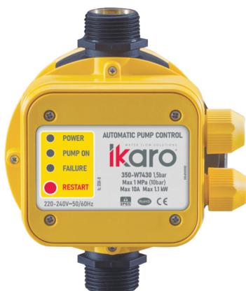
Regolatore automatico per elettropompe con manometro. Alimentazione 220V-240V, 50/60 Hz, IP 65. Adatto a motori di potenza max. 1.5 Hp (1.1 kw) pre pressione max 10 Bar. Temperatura max 60 °. Attacchi 1" maschio. Prodotto certificato corrispondente alle norme R.o.H.s. e TUV.
