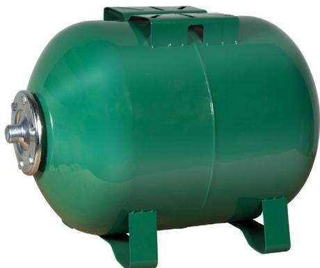
Sfera autoclave con membrana EPDM. Raccordo 1". Temperatura esercizio da -10 a +100°C. Pressione max 10 bar. Pressione prova 15 bar. Precarica 2 bar (24L) o 4 bar (50 e 100L).
